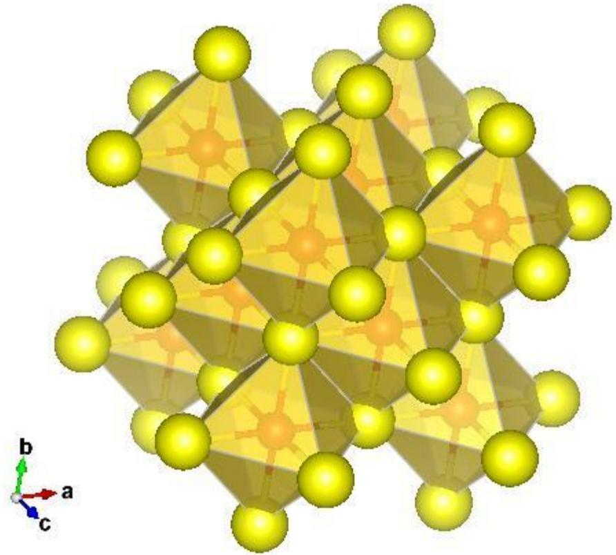
図9-1 NaClの結晶構造
