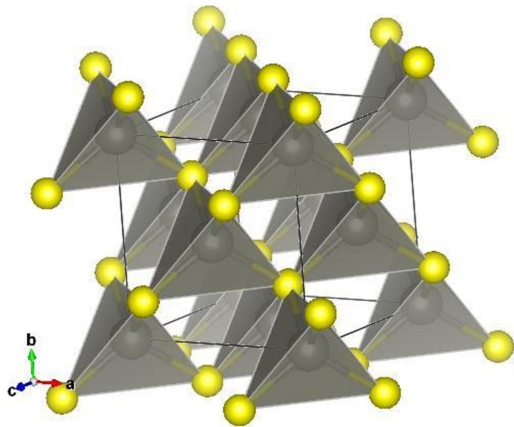
图9-2 閃亜鉛鋅構造
