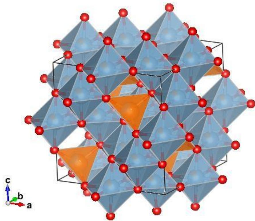
図9-9スピネル構造
