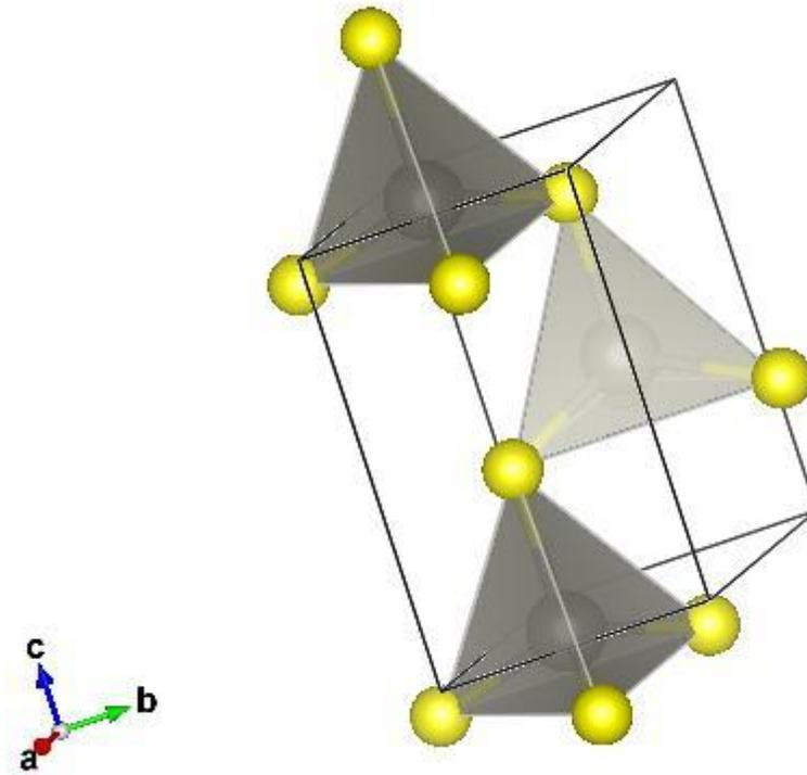
図9-3 ウルツ鉱構造
