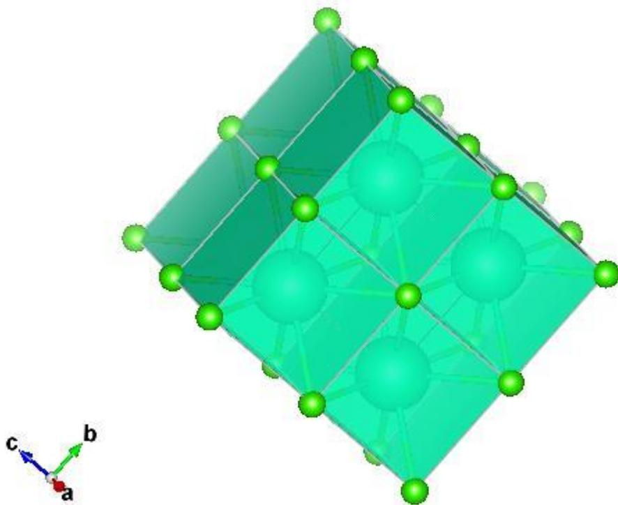
図9-5 塩化セシウム構造
