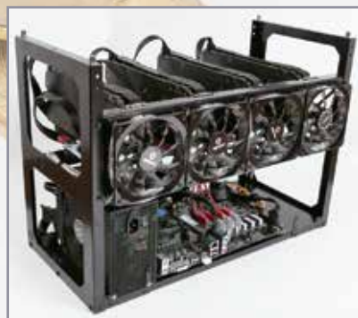
写真:強力なGPUを搭載するビデオカードを4枚使用したマイニングリグ
