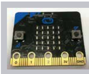
写真1 micro:bit 本体。小さい本体の中にたくさんの機能が
